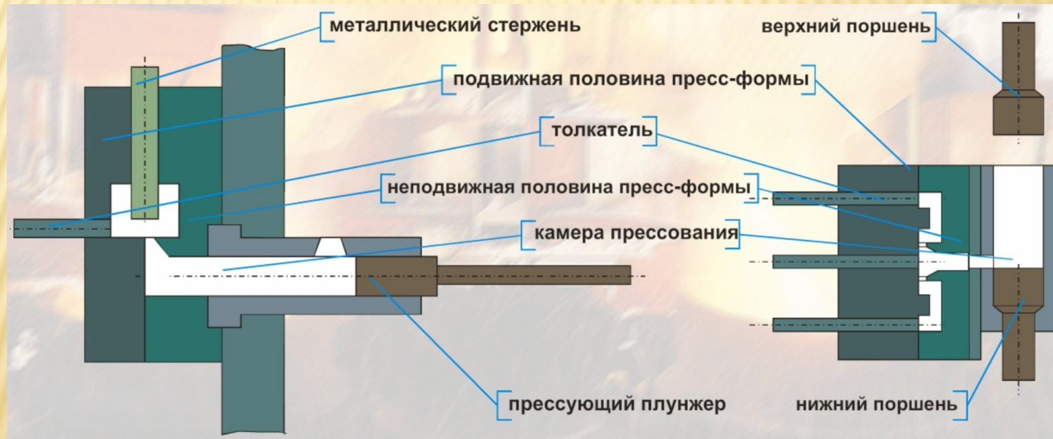
Горизонтальная камера прессования
