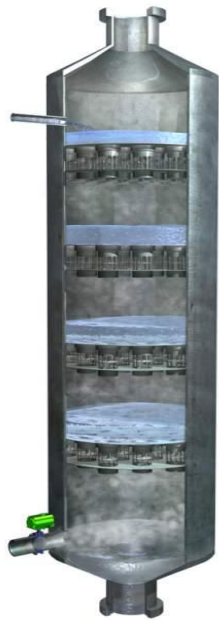
Ректификационная колонна с контактными элементами
