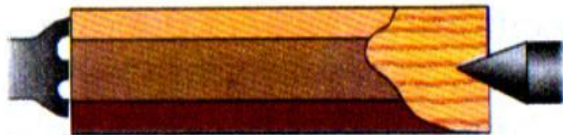
трезубцем с поджатием центром пиноли задней бабки
