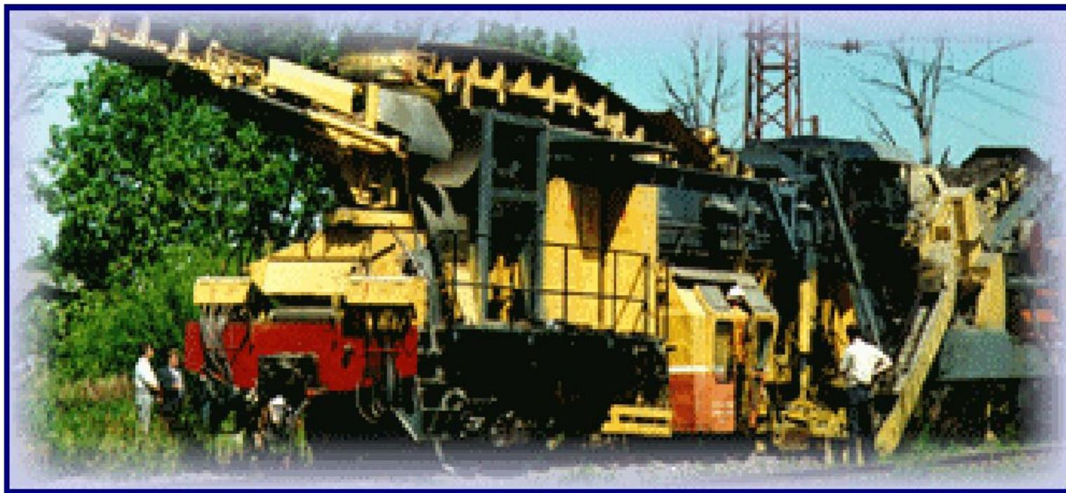
Баровая машина ЩОМ-6БМ предназначена для вырезки (без очистки или с очисткой) щебеночного балласта под рельсо-шпальной решеткой и за концами шпал с последующей дозированной укладкой чистого щебня в путь с распределением и формированием балластной призмы и постановкой пути в требуемое положение при среднем и капитальном ремонте жд. пути.
