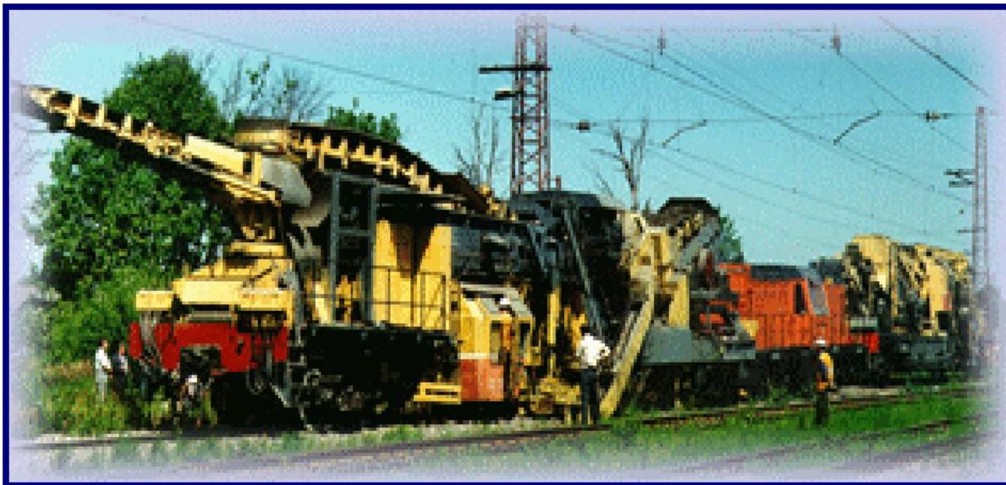
Комплекс ЩОМ-6 относится к новому поколению отечественных тяжелых путевых щебнеочистительных машин и предназначен для глубокой вырезки щебеночного балласта с понижением уровня железнодорожного пути и полной очистки щебня от загрязнителей при среднем и капитальном ремонте пути, а также при реконструкции балластной призмы.
