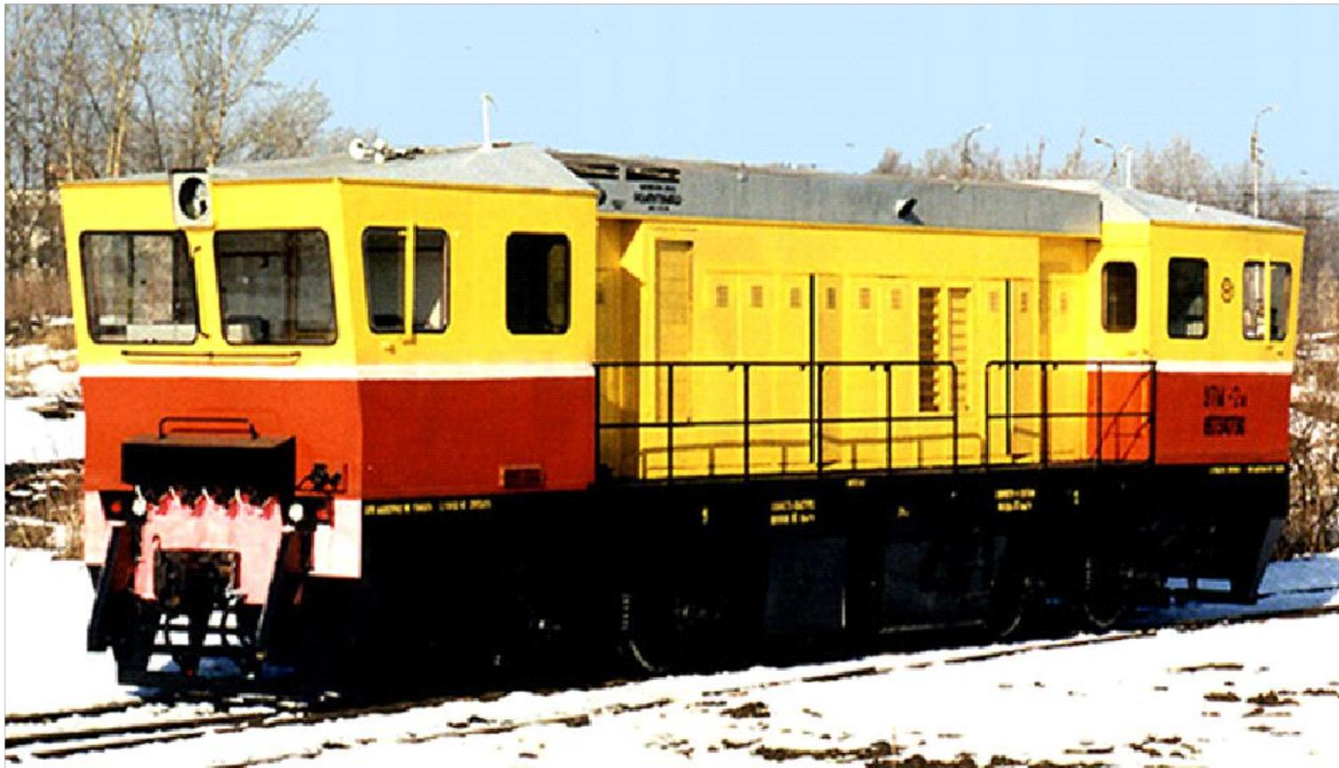
**МОДУЛЬ ТЯГОВЫЙ УНИВЕРСАЛЬНЫЙ УТМ-2М ПРЕДНАЗНАЧЕН ДЛЯ ТРАНСПОРТИРОВАНИЯ И СНАБЖЕНИЯ ЭЛЕКТРОЭНЕРГИЕЙ ТЯЖЕЛЫХ ПУТЕВЫХ МАШИН СЧ-600, СЧ-601, СЗП-600, СЧУ-800 И ДРУГИХ, НЕ ИМЕЮЩИХ ИСТОЧНИКОВ ПИТАНИЯ 3Х380 В, 50 ГЦ. МОДУЛЬ МОЖЕТ ЭКСПЛУАТИРОВАТЬСЯ В УСЛОВИЯХ УМЕРЕННОГО КЛИМАТА КАТЕГОРИИ РАЗМЕЩЕНИЯ I ПО ГОСТУ 15150-69 ПРИ ТЕМПЕРАТУРЕ ОТ -10°С ДО +40°С С ЗЕМЛЕРОЙНЫМИ МАШИНАМИ, А С ДРУГИМИ ПУТЕВЫМИ МАШИНАМИ ПРИ ТЕМПЕРАТУРЕ ОТ -40°С ДО +40°С И ВЫСОТЕ НАД УРОВНЕМ МОРЯ ДО 1000 М.**
