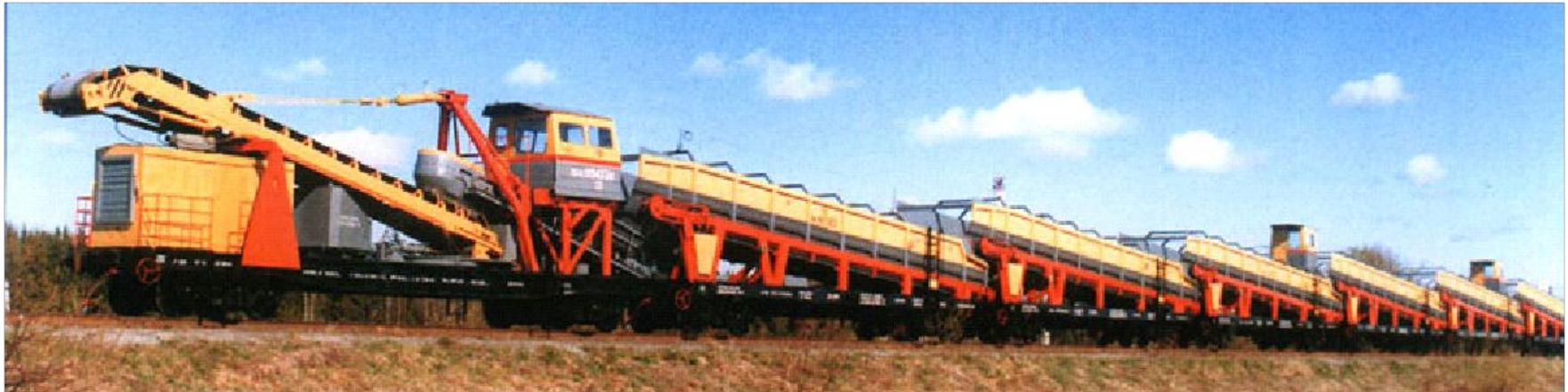
Состав для вывозки засорителей СЗ-240-6, состоящий из шести универсальных полувагонов и одного концевой, предназначен для механизированного наполнения при производстве путевых работ, транспортирования к месту выгрузки засорителей, загрязненного щебня, сыпучих материалов в отведенных местах.
