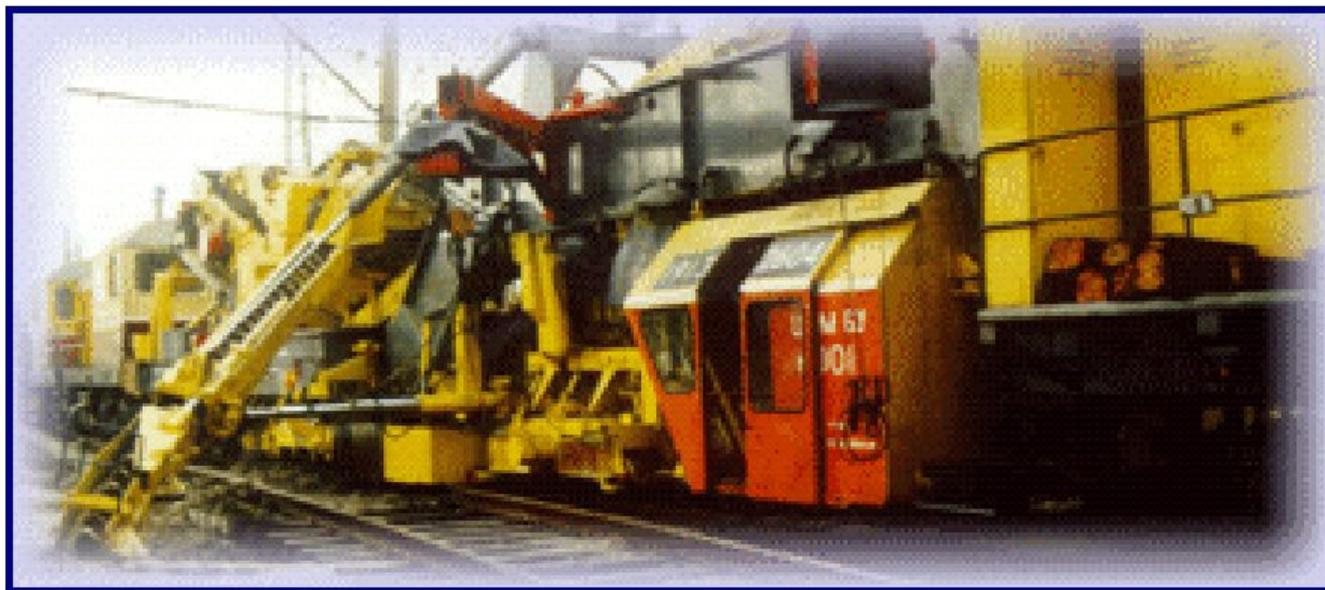
Машина предназначена для выполнения работ по глубокой вырезке и очистке балласта пути с колеей 1520 мм, деревянными или железобетонными шпалами и рельсами типа Р50 и Р75 как при обработке стрелочных переводов без их демонтажа, так и магистральных и станционных путей, включая пути у высоких платформ, при среднем и капитальном ремонте.
