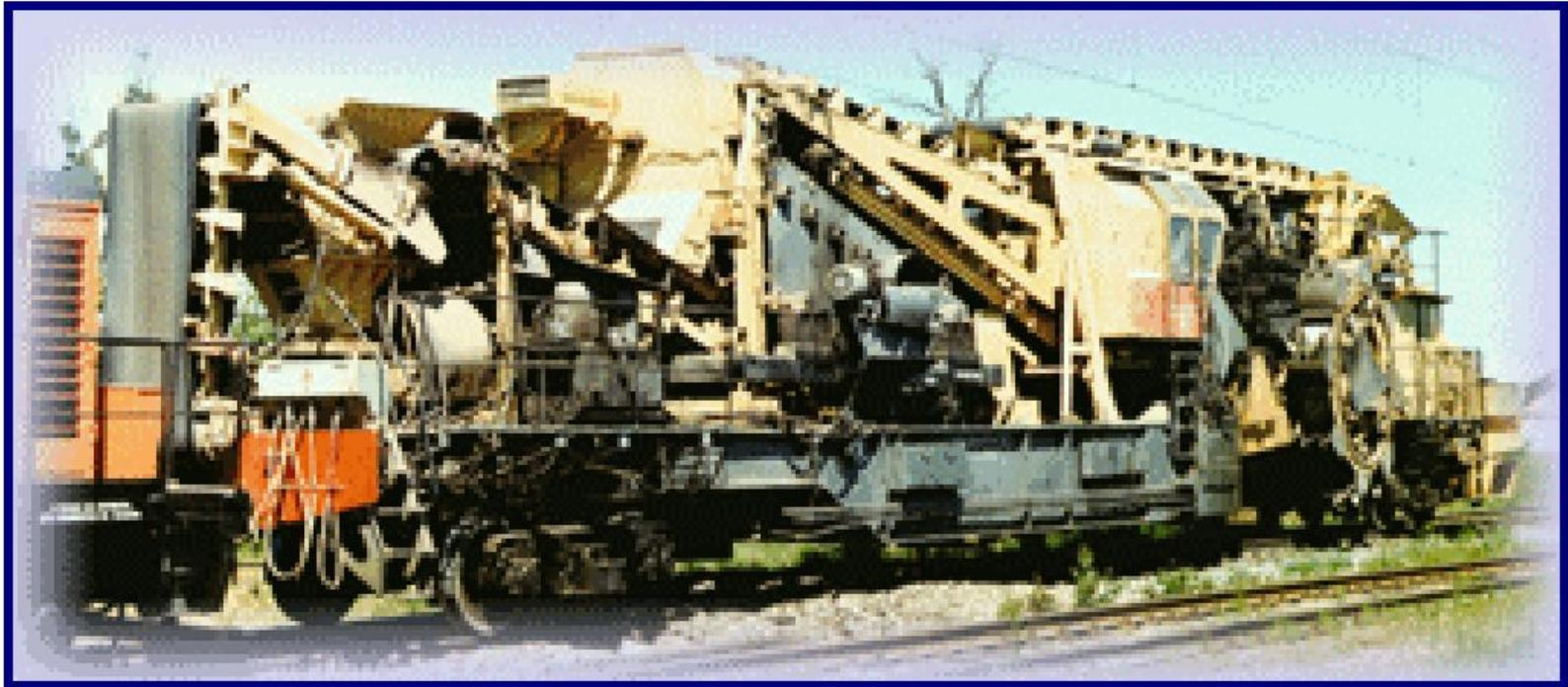
Роторная машина ЩОМ-6РД предназначена для вырезки (без очистки или с очисткой) щебеночного балласта за концами шпал с последующей дозированной укладкой чистого щебня в путь, а также с отбором очищенного щебня в спецсостав.
