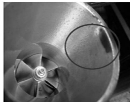
Утечка масла из воздухозаборного отверстия
