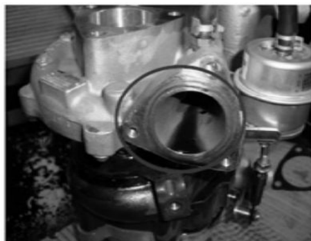
Утечка масла на месте воздуховыпускном отверстии нагнетателя
