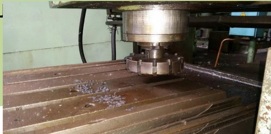
Продольно-фрезерный станок двухстоечный -стол перемещается по направляющим станины только в продольном направлении
