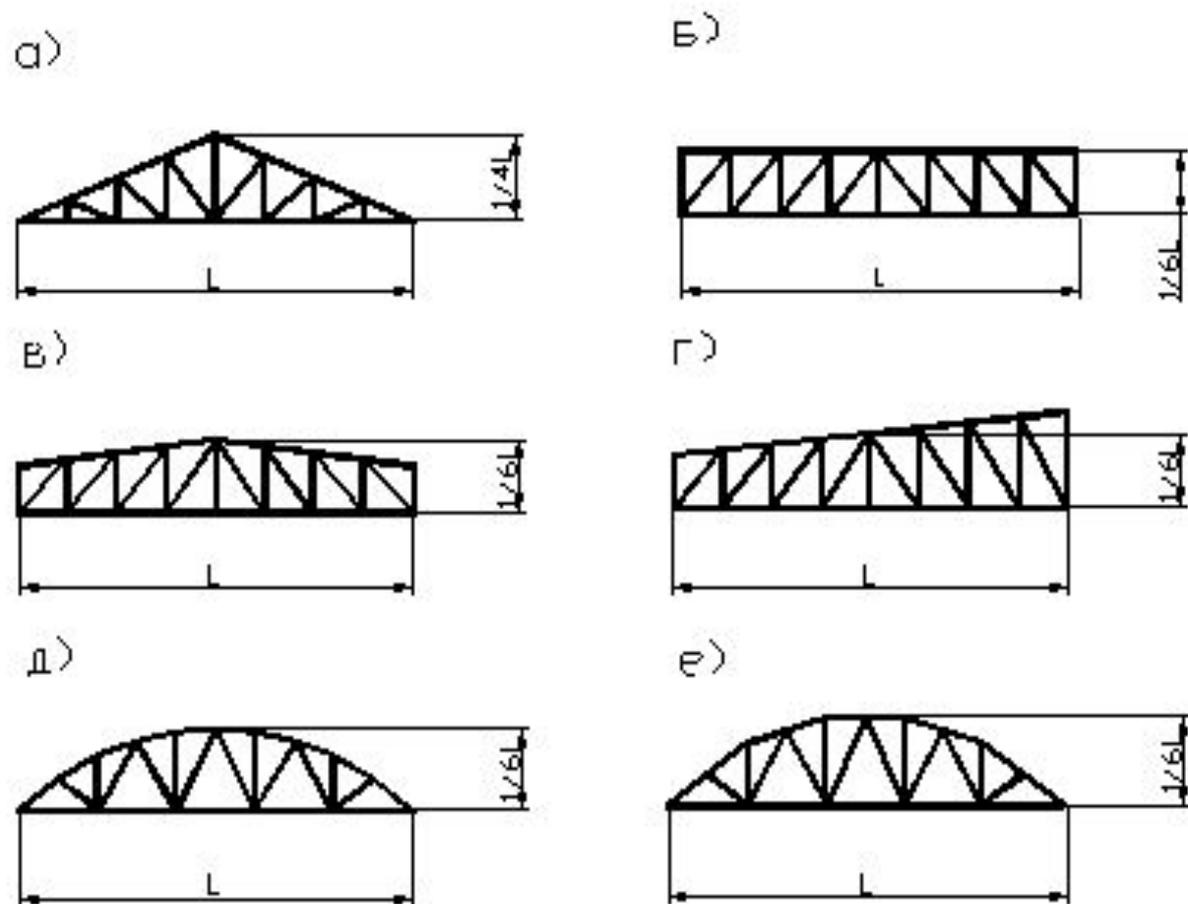
Рис. 1 Схемы деревянных ферм -
