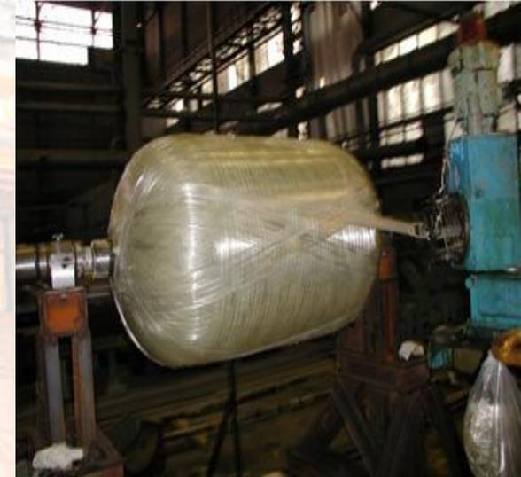
Метод намотки – один из наиболее прогрессивных и эффективных методов получения изделий из углепластиков.
