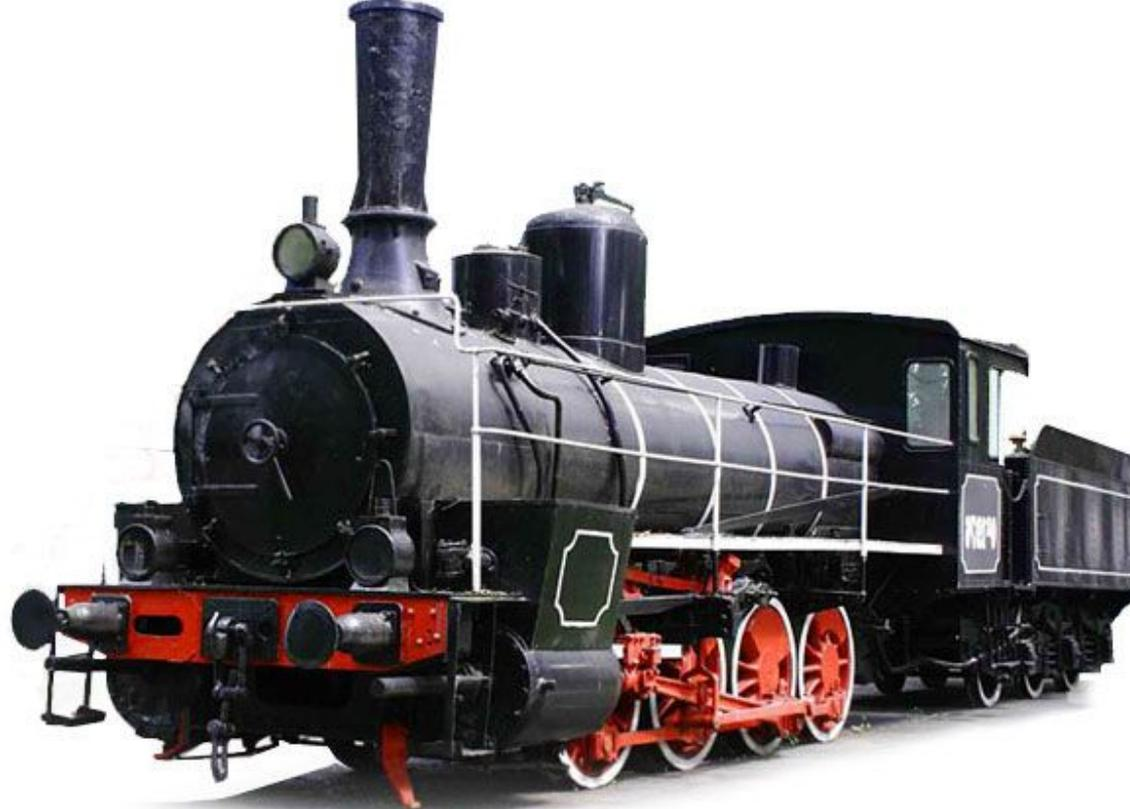
В 1908 году заводскими инженерами создан пассажирский локомотив серии «Б», развивавший скорость 120 км/ч. К 1910 году завод построил более 2400 паровозов и более 36 тысяч вагонов, в том числе специализированных платформ и нефтяных цистерн.
