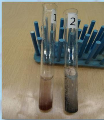
Как катализаторы в 1-ой пробирке оксид железа (III), во 2-ой оксид меди (II).
