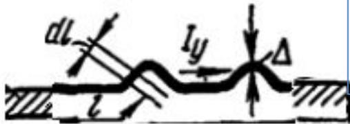
Условие перекрытия: сопротивление дуги  $\leq$  сопротивлению пленки загрязнения, это достигается при некотором значении тока утечки  $I_{ук}$
