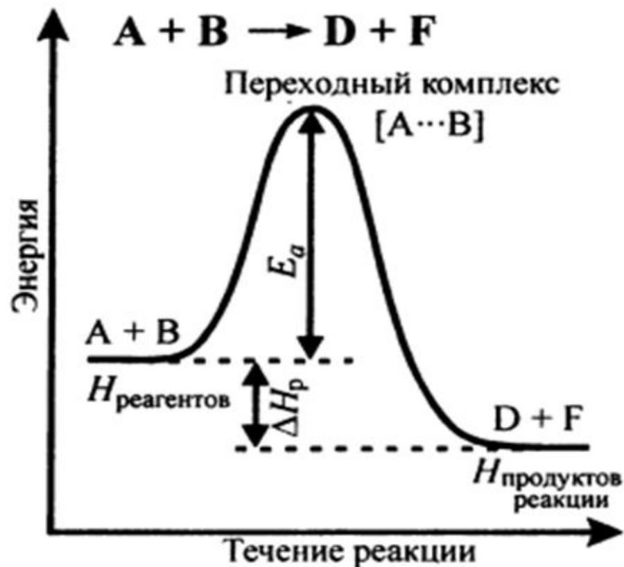
Рис. 6. Энергетический профиль реакции
