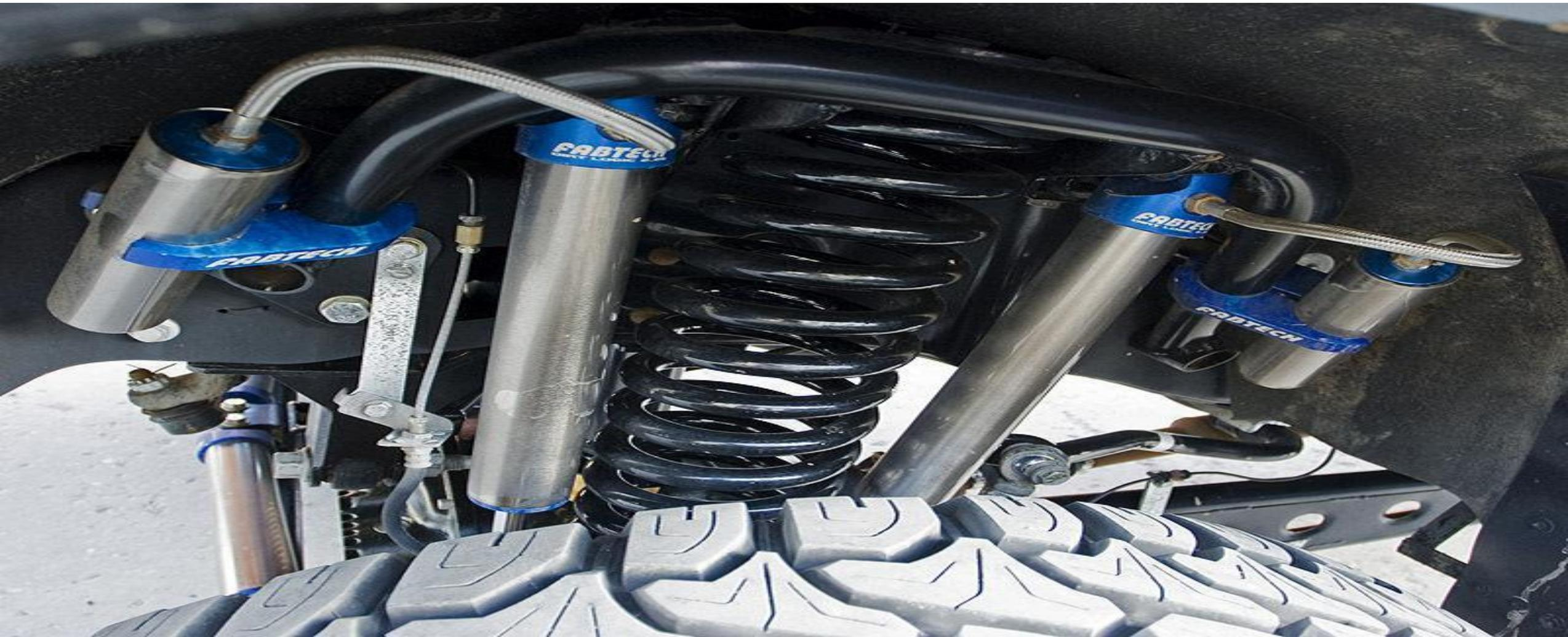
Универсальность этого решения дополняется применением амортизаторов с регулируемой жесткостью. С установкой жестких пружин желательно установить и жесткие стабилизаторы поперечной устойчивости
