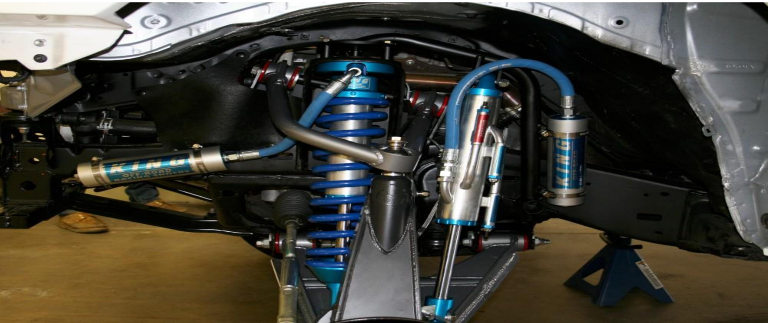
Однако у спортивных амортизаторов есть и свои недостатки. Из-за их жесткости улучшается управляемость автомобилем, но из-за жестких амортизаторов также ускоряется износ иных деталей подвески
