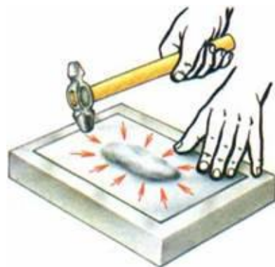
Рис. 5. Правка листового металла.
