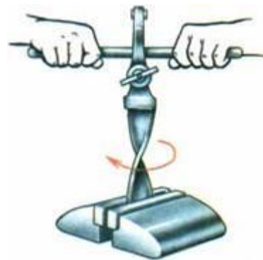
Рис. 3. Правка скрученной полосы.
