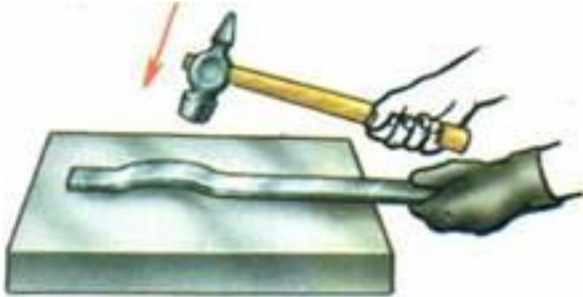
Рис. 4. Правка круглого прутка на плите.
