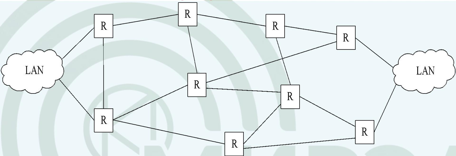
Возможные маршруты обмена IP пакетами между двумя локальными сетями или компьютерами (две вершины графа) могут быть определены как совокупность маршрутизаторов, которые связаны между собой определенным образом. Среднее число маршрутизаторов в тракте передачи IP пакетов с 1998 по 2001 год увеличилось с 18 до 20. Понятно, что такая тенденция стимулирует пересмотр принципов построения сети Internet.
