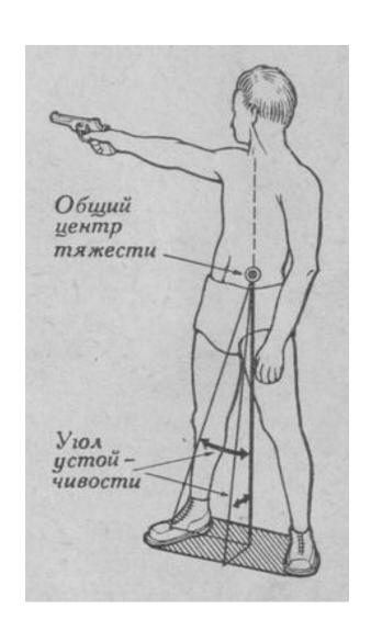
3. Угол устойчивости – угол между линией тяжести и линией, проходящей через ребро опрокидывания.
