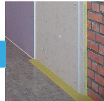
Межквартирная перегородка 200 мм, плотность - 600
