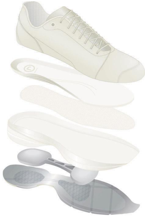
Расположение воздушной подушки в промежуточной подошве
