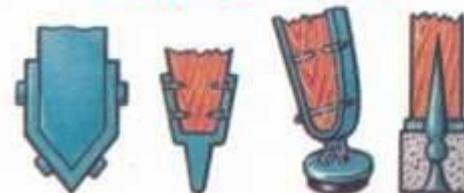
151. Верхние концы лестниц, приставляемых к трубам или проводам, снабжаются специальными крюками-захватами, предотвращающими падение лестницы от напора ветра или случайных толчков.
