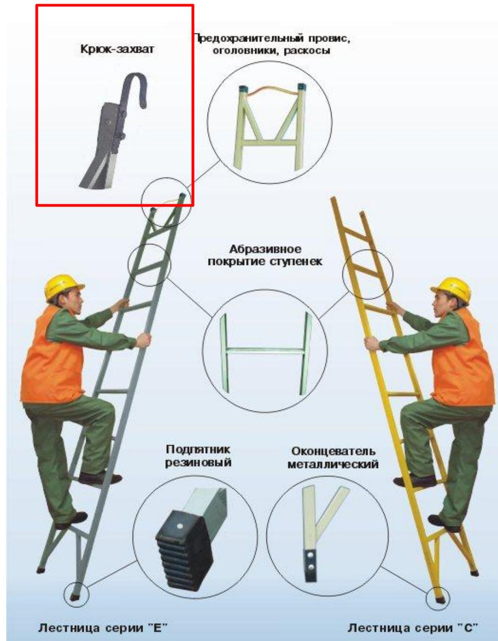
152. Устанавливать и закреплять лестницы и площадки на монтируемые конструкции следует до их подъема. Длина приставной лестницы должна обеспечивать работнику возможность работы в положении стоя на ступени, находящейся на расстоянии **не менее 1 м от верхнего конца лестницы**.
