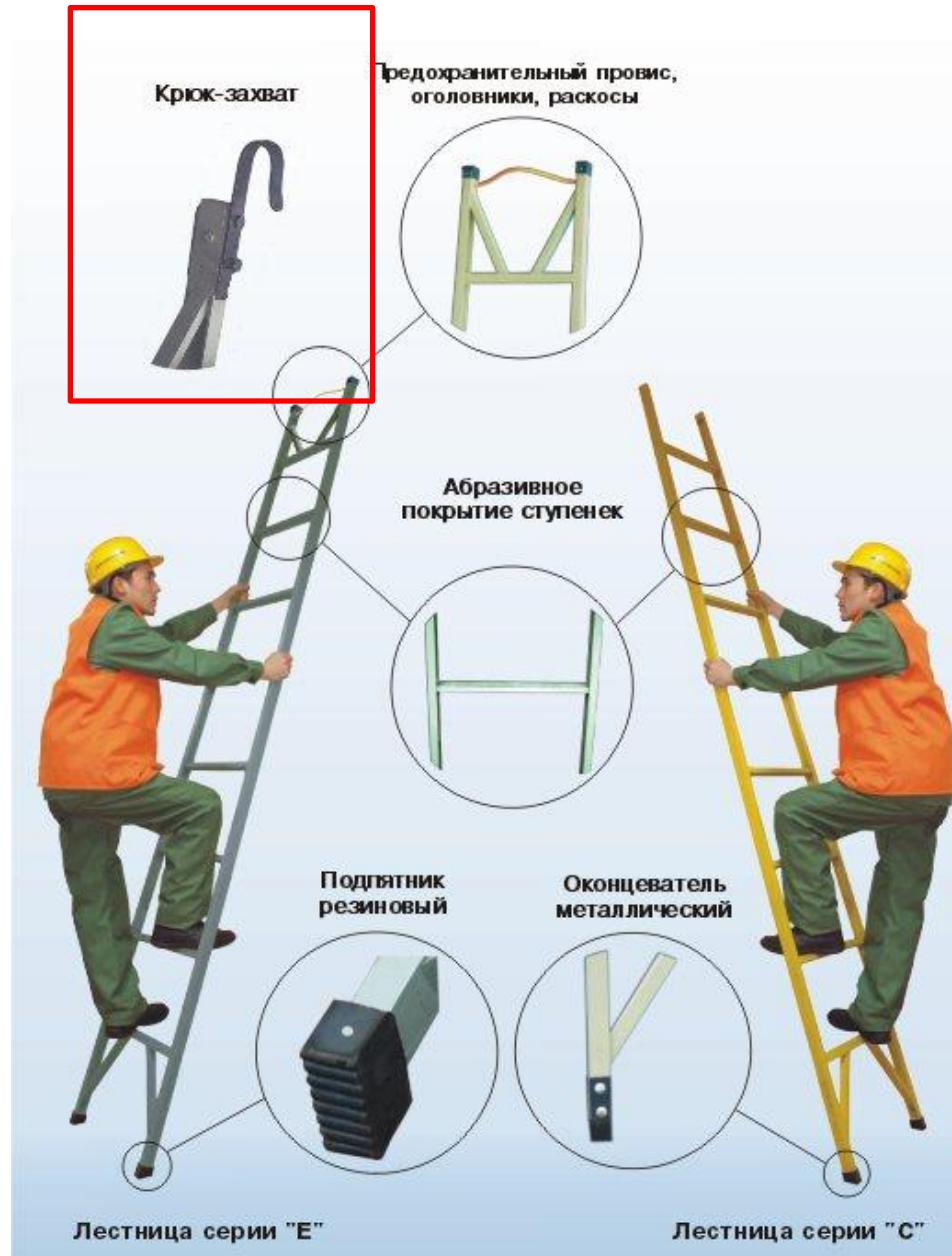
152. Устанавливать и закреплять лестницы и площадки на монтируемые конструкции следует до их подъема. Длина приставной лестницы должна обеспечивать работнику возможность работы в положении стоя на ступени, находящейся на расстоянии **не менее 1 м от верхнего конца лестницы**.
