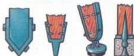
151. Верхние концы лестниц, приставляемых к трубам или проводам, снабжаются специальными крюками-захватами, предотвращающими падение лестницы от напора ветра или случайных толчков.
