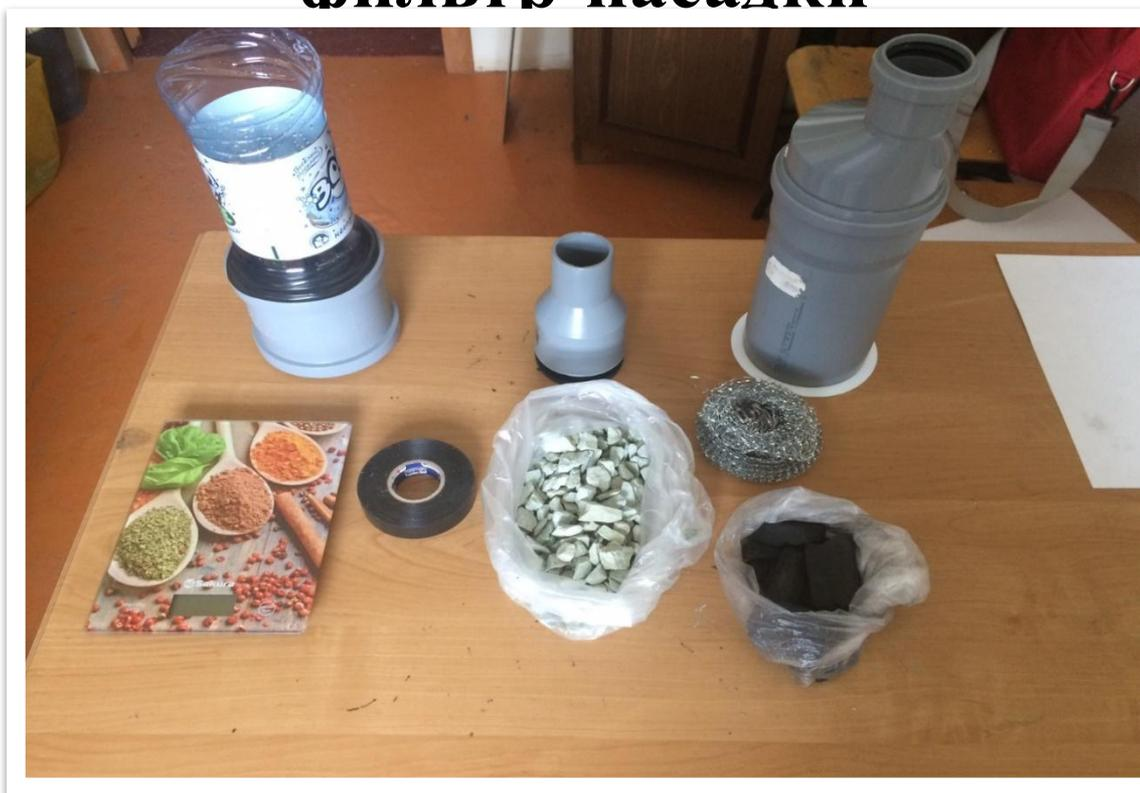
Фильтр насадка состоит из пластиковой цилиндрической трубы 110x2,7x150 мм, редукция 110/50, решетка круглая 110 мм для разделения фильтрующих материалов, переходник пластиковый 50/75 для установки фильтр-насадки на выхлопную трубу автомобиля, крышка с решеткой 110 мм. Фильтрующими элементами были выбраны металлическая стружка, цеолит, активированный уголь
