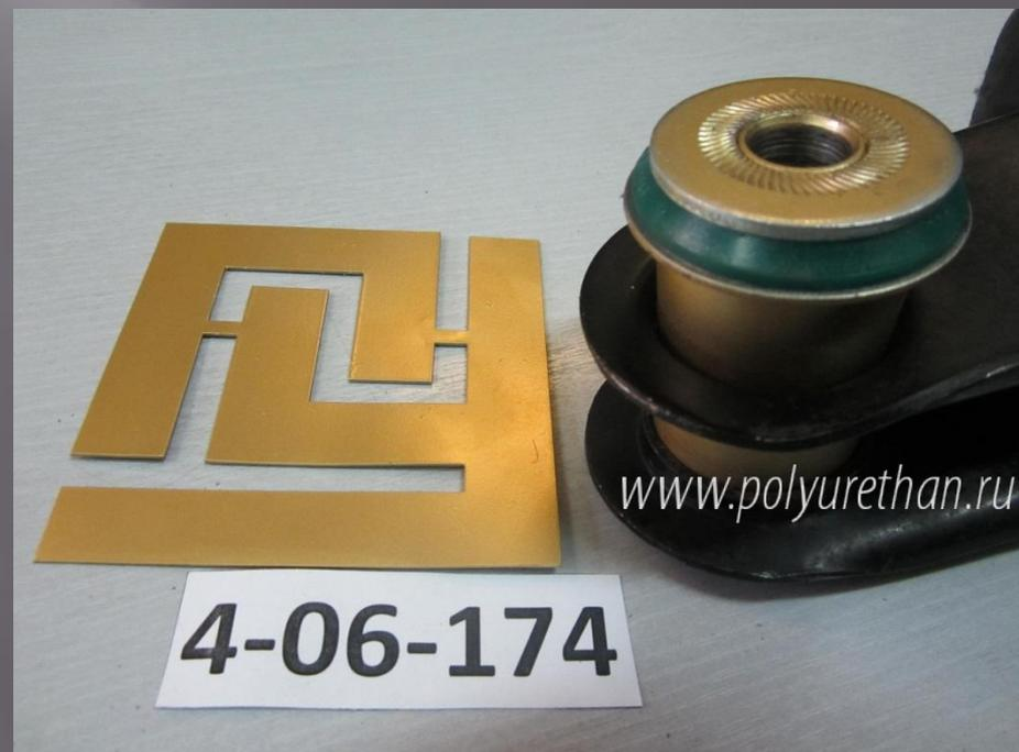
Сайлентблоки, имеющие на наружном торце отбортовку, прессуются аналогично. Требование только одно: отверстие в оправке не должно подрезать торцевой полиуретановый слой.
