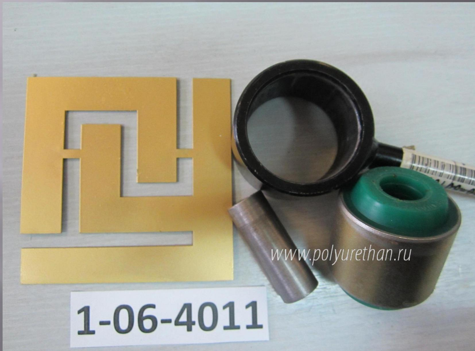
При прессовании полиуретановых изделий, имеющих по конструкции неприваренную внутреннюю втулку, иногда целесообразно прессовать отдельно полимерное изделие в место установки, а затем уже в него — металлическую втулку. Требования к поверхностям, фаскам, оправкам и смазке
