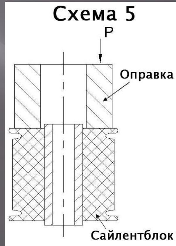
Бывает, что внутренняя втулка выступает по длине за габариты наружной поверхности незначительно (до 2-3 мм). В таком случае оправка для запрессовки может не иметь центрального отверстия (схема 6), все остальные *требования* должны быть соблюдены. Усилие пресса можно прилагать прямо на внутреннюю
