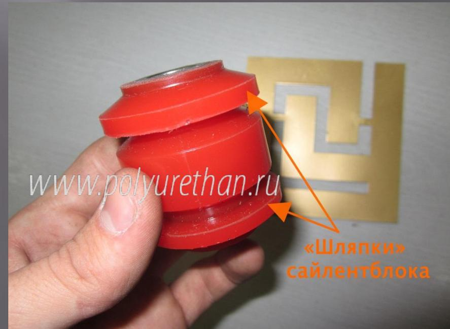
Если это не обеспечено с первого раза, возможно приложить усилие запрессовки еще раз с нужной стороны до выравнивания расположения детали в рычаге (тяге).
