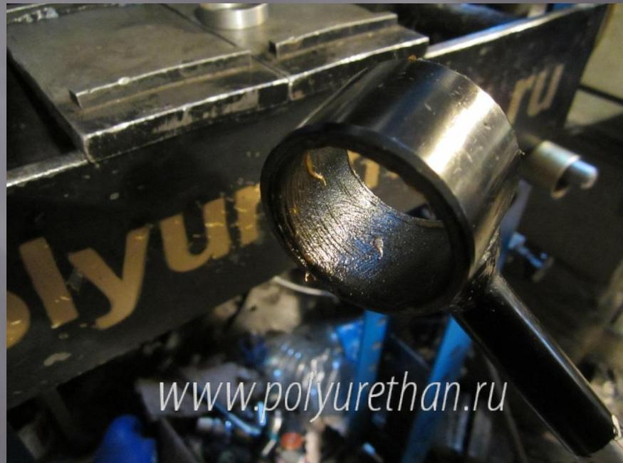
Перед установкой поверхность посадочного места обязательно должна быть обработана достаточным количеством смазки. Когда сайлентблок зайдет в установочное отверстие не менее, чем на половину своей длины, рекомендуется кратковременно снять усилие прессования для того, чтобы полиуретановый слой сайлентблока смог свободно заполнить выборки (канавки) на поверхности, специально для этого выполненные при изготовлен
