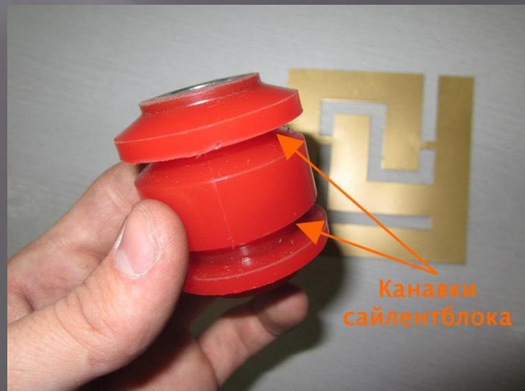
Окончательно снимать усилие прессования необходимо по достижению верхней кромки полиуретанового слоя (шляпки, бурта), не допуская ее подрезание о край отверстия рычага или тяги. Запрессованный сайлентблок должен выступать за габариты установочного места одинаково (как правило).
