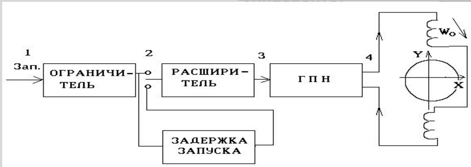
Рис.6.13. Упрощенная структурная схема канала развертки дальности
