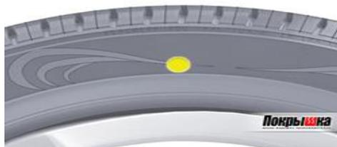
**Красная маркировка (красная точка на шине)** - означает место максимальной силовой неоднородности, проявление которой обычно связано с различными соединениями разных слоев шины при её изготовлении. Эти неоднородности - абсолютно нормальное явление, и они есть у всех шин. Но обычно помечают красными точками только те шины, которые идут на первичную комплектацию автомобилей, т.е. когда машина выходит с завода.
