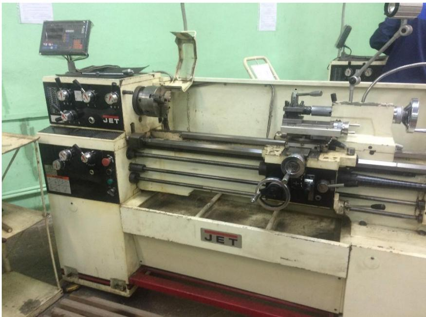
Этот токарный станок предназначен исключительно для токарной обработки и сверления металлов и полимерных материалов, поддающихся обработке резанием.
