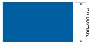
высота окраски цоколя и кровли
