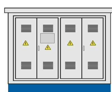
вид спереди КТП 6–10/0,4 кВ с бетонной кровлей
