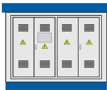
вид спереди КТП 6–10/0,4 кВ с металлической синей кровлей
