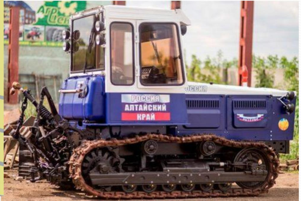
Тракторы класса 5 (ЗАО «Петербургский тракторный завод») — используют для вспашки, культивации, лущения стерни, посева, снегозадержания на большой площади и транспортирования. Мощность дизеля этих колесных тракторов до 257,6 кВт (350 л. с.)<sup>1</sup> - Разработан гусеничный трактор Т-250 этого тягового класса.
