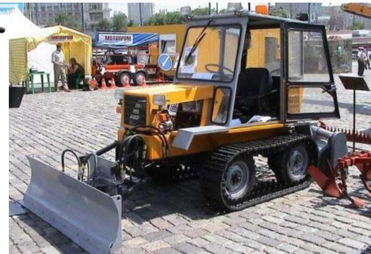
Тракторы и самоходные шасси класса 0,6 (ОАО «Владимирский тракторный завод») — служат для выполнения междурядной и предпосевной обработок, посева, посадки овощных культур и садов, ухода за посевами, уборки сена, транспортных работ, а также для привода в действие стационарных машин.
