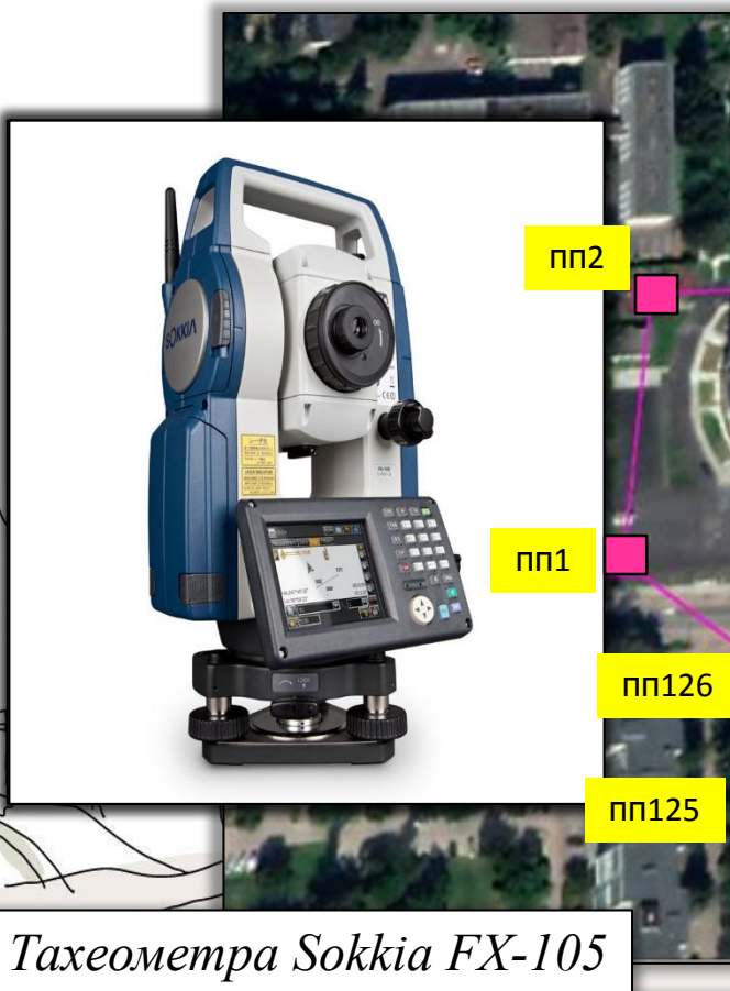
Схема разбивочной сети строительной площадки
