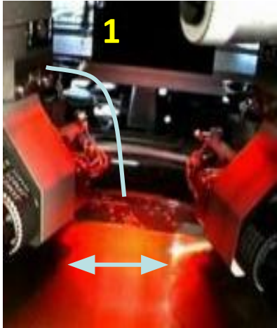
1. Кремниевая пластина с чипами помещается на горизонтальный столик. Захват-1 опускается на пластину
