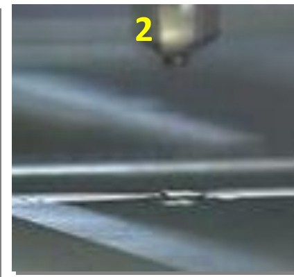
8. Захват-2 отпускает чип и возвращается к захвату-1. Антенна удерживает чип, образуя с ним электрический контакт
