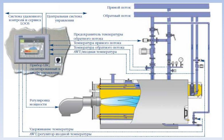
Работой водогрейных котлов управляет система безопасности и регулирования, собранная в шкафу. Функции примененной системы:
