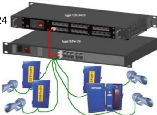
Рисунок 5.2 AGAT RPw-24 с подключением ТА и Ревунов
