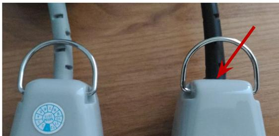
У подделки дата производства указывается наклейкой – окружность с секторами. У оригинала никаких наклеек не бывает. Дата производства (из трех цифр: первые две – месяц, последняя – год; например, 065 – июнь 2015 года) наносится тонким штампом в торце корпуса в месте обозначенном стрелкой. Только надо внимательно присмотреться.
