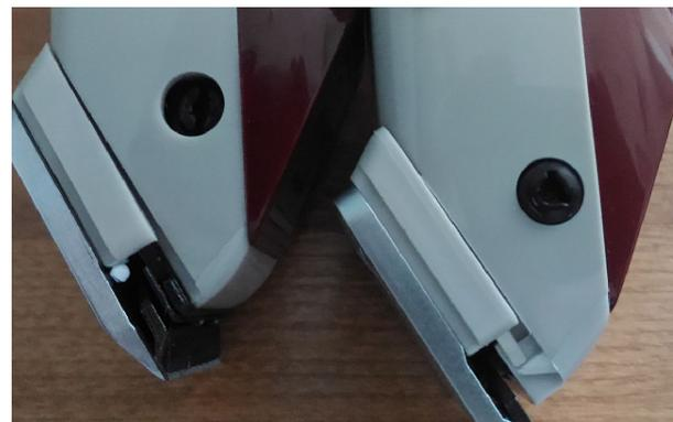
Черный винт регулировки хода якоря у оригинала (справа) выступает за края корпуса. Он установлен ровно и плотно в отверстие. И сделан он под специальную отвертку. Винт подделки «провален» в глубину корпуса и имеет шлиц под обычную отвертку.
