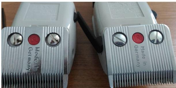
На нижнем ноже оригинала (справа) специальным штампом выдавлена фраза "Made in Germany", а на подделке слева с ошибкой – "Mode in Germany". Нож в Германии полируют по специальной технологии. Нож подделки (видимо из дешевой стали) просто покрывают хромом, чтобы он блестел. Обычный обман покупателя. При увеличении фото видно, что тех.табличка на сером пластике у оригинала имеет большую глубину и четкость шрифта.
