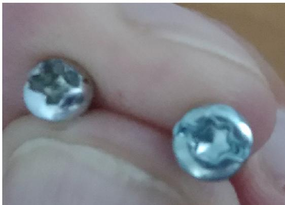
Винты корпуса (верхней, бордовой крышки) у оригинала сделаны под отвертку стандарта Philips T10 (звездочка с 6 шлицами). Также имеется длинный шлиц под обычную «плоскую» отвертку. У подделки головка винта визуально меньше и сделана под обычную «крестовую» отвертку. Китай не заморачивается!
