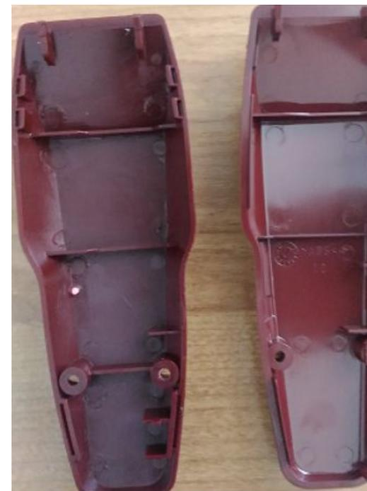
После снятия верхней крышки видим на подделке слева следы пластикового облоя (кусочки пластмассы оставленные прессом), лишние торчащие, непонятные «ребра». Оригинал чище, ровнее и имеет технический штамп в форме окружности и цифры. При откручивании винтов верхней крышки вместе с винтом стали выходить кусочки пластмассы. Гнездо под винт стало просто крошиться. Понятно, что корпус изготовлен из самого дешевого пластика.
