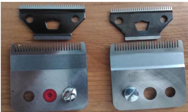
На подделке слева видно, что поверхность нижнего ножа была отполирована (а это неправильно). Но на оригинале видна еще и мелкая «сеточка» от специальной шлифовки. В ее бороздках сохраняются частицы масла, обеспечивая снижение трения. Канавка у оригинал также полирована, а на подделке она черная.
