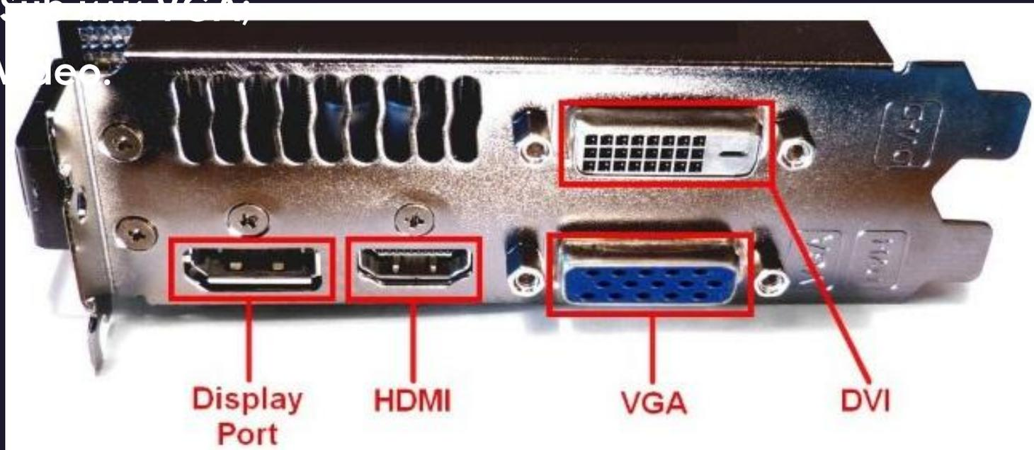
DVI (Digital Visual Interface) — наиболее распространенный интерфейс, который бывает в трех вариантах: DVI-D (цифровой), DVI-A (аналоговый), DVI-I (комбинированный). В дискретных видеокартах обычно присутствует DVI-I, как наиболее универсальный.
