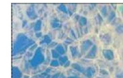
Макро и микро структура: 1 – экструзионный пенополистирол; 2 – бисерный пенополистирол
