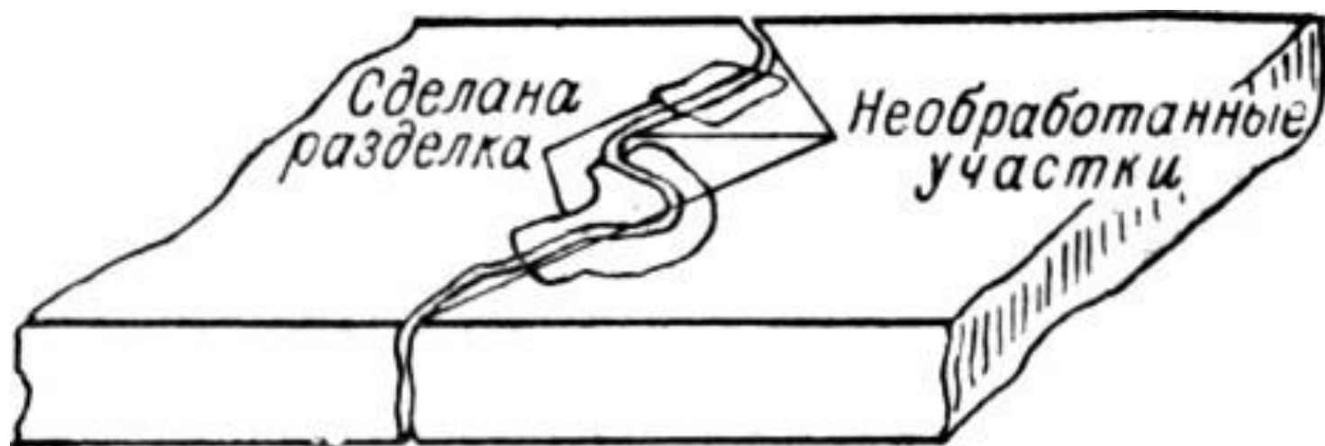
Рис. 56. Подготовка к сварке сломанной детали
