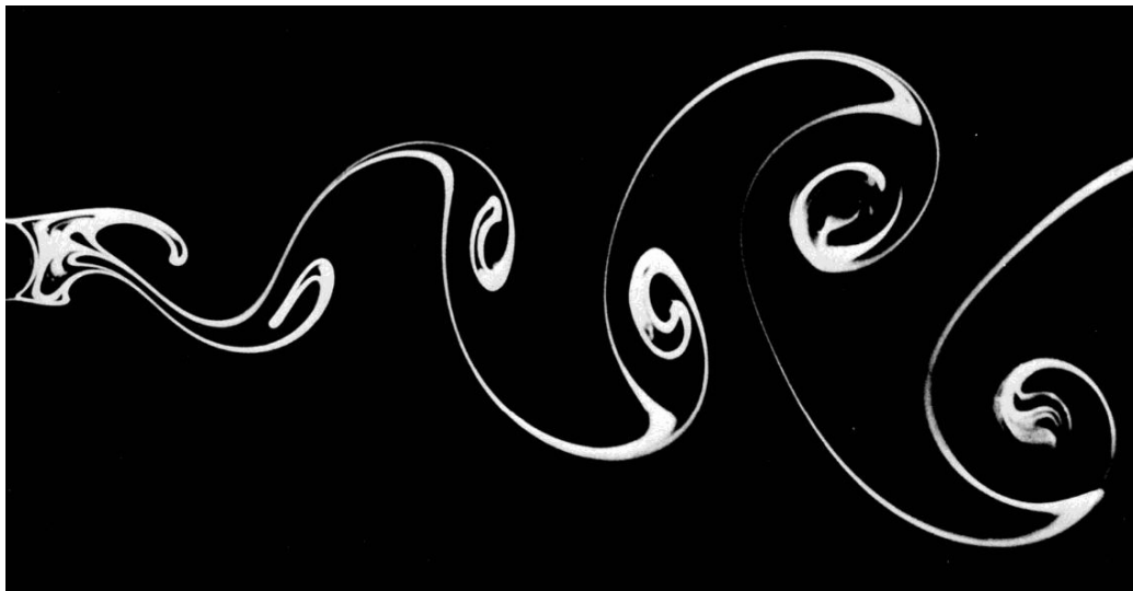
Вихревая дорожка Кармана за круговым цилиндром при Re=140
