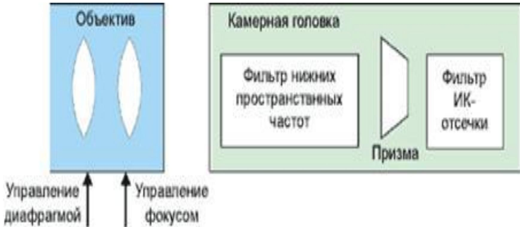
Оптическая часть видеокамеры
