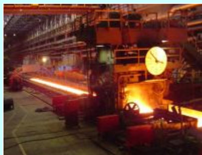
Черновая и чистовая клетка кварто предназначены для прокатки слябов, получения толстолиствого проката, а также подката для стана «1700».
