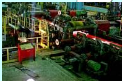
Моталки – 2шт., смотка полос в рулоны. Максимальная масса сматываемого рулона 15 т.
