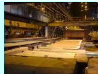
2 роликовые печи, общей производительностью по каждой печи 30тн/час. 1-я роликовая печь предназначена для нормализации и отпуска металла, а 2-я дополнительно еще и закалка металла.
