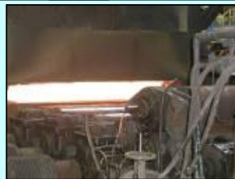
2 роликовые печи, общей производительностью по каждой печи 30тн/час. 1-я роликовая печь предназначена для нормализации и отпуска металла, а 2-я дополнительно еще и закалка металла.
