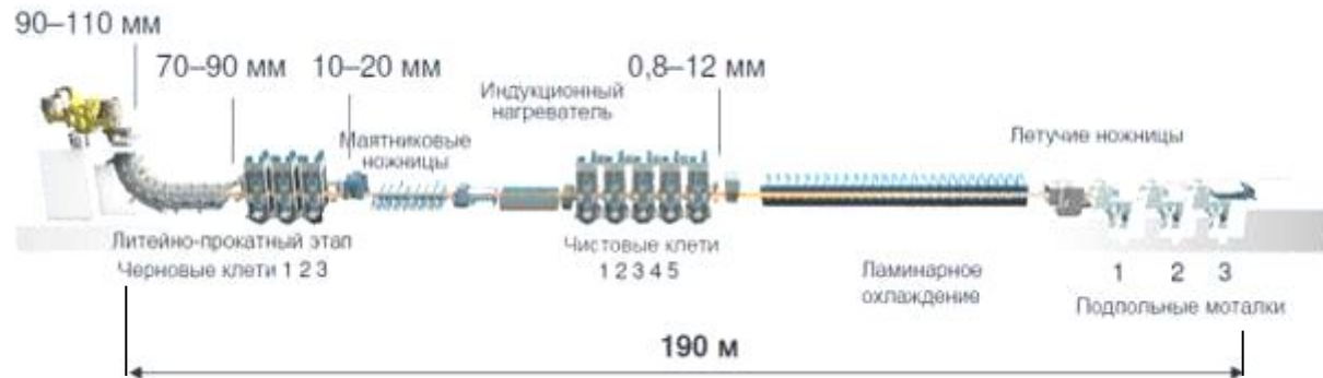
Установка ESP (Endless Strip Production)
