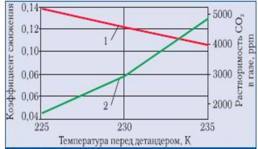
Коэффициент сжижения (1) и растворимость диоксида углерода в газе (2) в зависимости от температуры перед детандером при давлениях прямого потока 3,5 МПа и обратного 0,6 МПа
