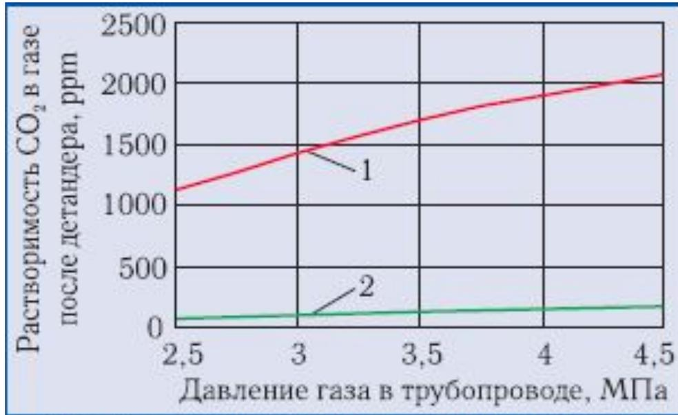
Растворимость диоксида углерода в газе после расширения в детандере при оптимальных параметрах технологического потока и различных давлениях газа после детандера, МПа: 1 – 0,6; 2 – 0,2
