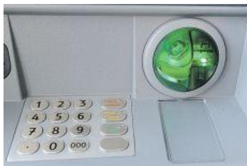
Фальш-накладка для считывания магнитной полосы карты
