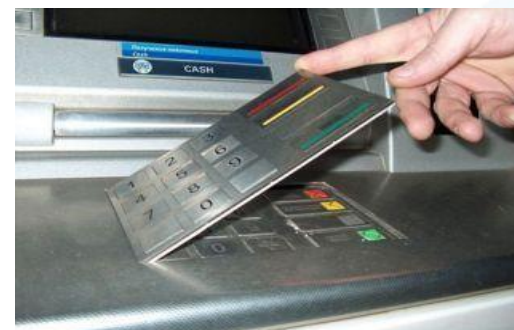
Накладная клавиатура для считывания ПИН-кода карты
