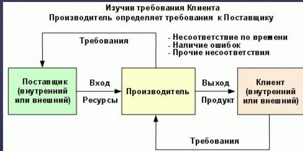
После разработки схемы бизнес-процесса "как надо" следует пройтись от конца процесса к его началу и последовательно для каждой работы бизнес-процесса применить модель "Поставщик-производитель-клиент".
