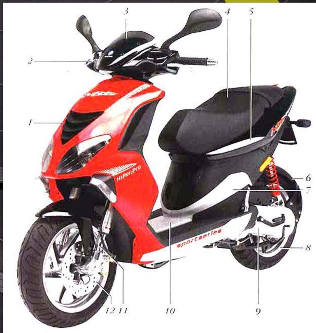
К ходовой части мопеда относятся оба колеса, тормозная система и подвеска. Именно благодаря подвеске, которая обеспечивает связь колёс с рамой, вибрации при езде гасятся, а торможения или набор скорости осуществляются плавно и мягко.
