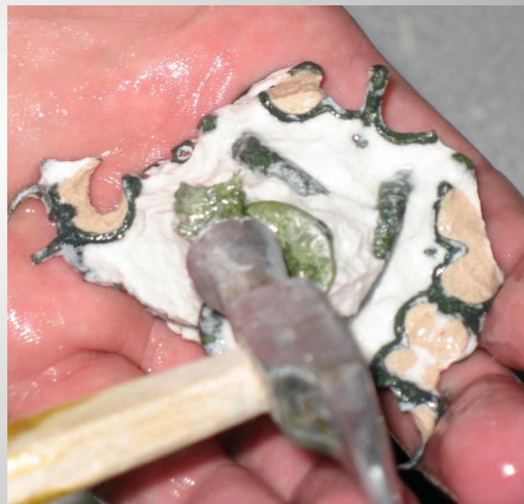
С полученного каркаса с помощью бормашины удаляются литники и облой.
