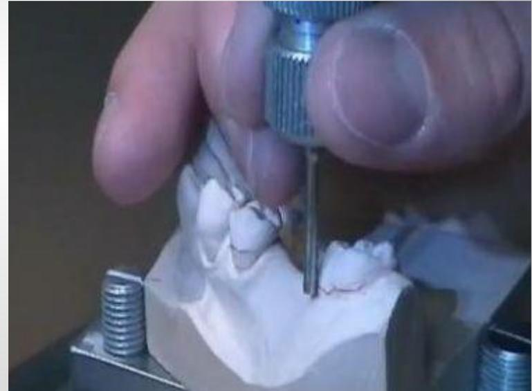
С помощью калибров для измерения поднутрений определяется положение ретенционных точек .
