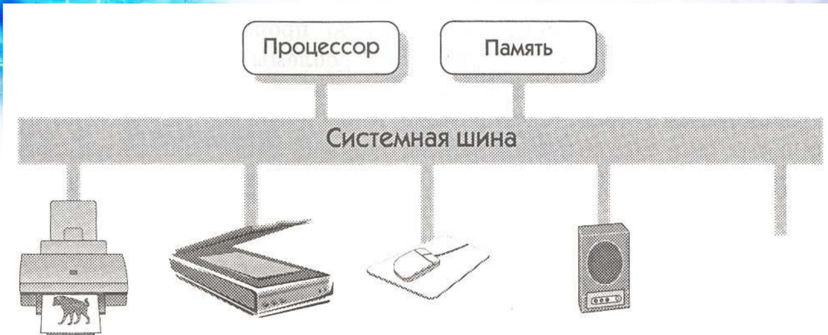
Системная шина – информационная магистраль, которая связывает друг с другом все устройства компьютера (группа токопроводящих кабелей или линий на системной плате)
