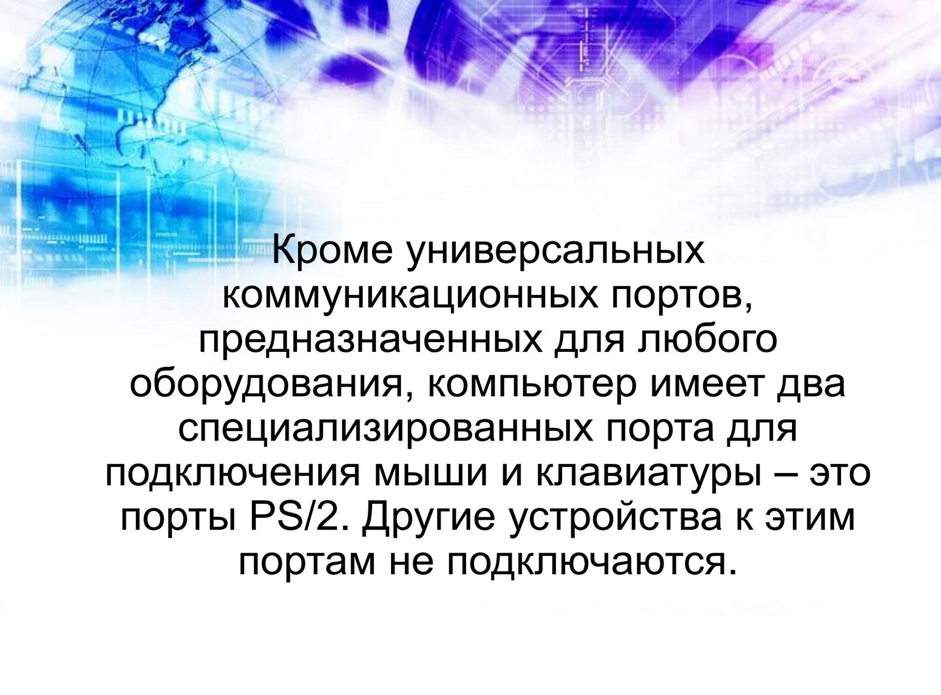
Кроме универсальных коммуникационных портов, предназначенных для любого оборудования, компьютер имеет два специализированных порта для подключения мыши и клавиатуры – это порты PS/2. Другие устройства к этим портам не подключаются.
