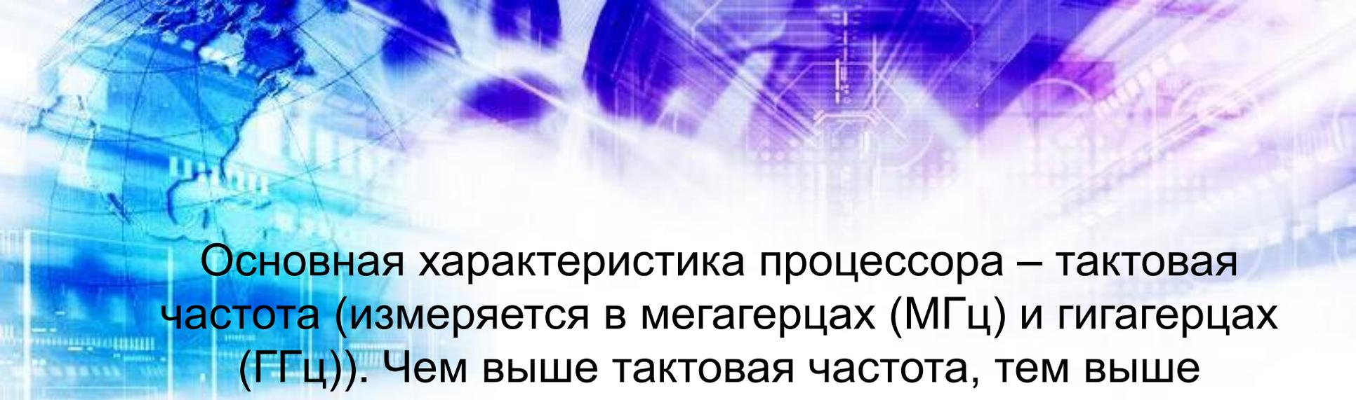
Основная характеристика процессора – тактовая частота (измеряется в мегагерцах (МГц) и гигагерцах (ГГц)). Чем выше тактовая частота, тем выше производительность компьютера. Так, например, при тактовой частоте 2000 МГц процессор может за одну секунду изменить свое состояние 2000 миллионов раз.
