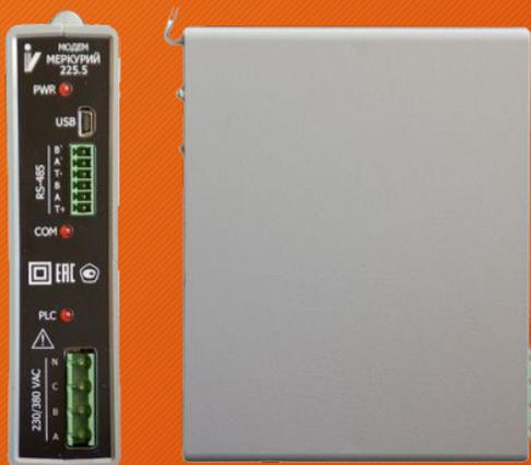
Системный PLC-модем «Меркурий 225.5» (совместно с УСПД М250.5) используется для организации централизованной системы сбора данных со счетчиков М208/М238. Оптимальным местом расположения этого устройства является трансформаторная подстанция либо другое равноудаленное от приборов учета место, с возможностью подключения к трем фазам силовой сети.
