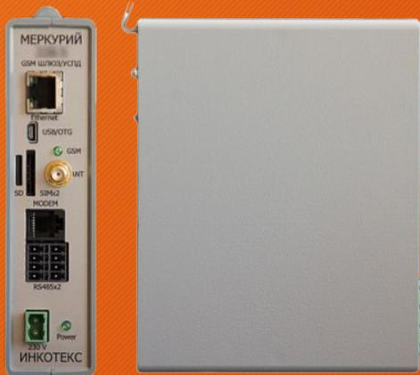
УСПД «Меркурий 250.5» представляет собой компактный промышленный компьютер и предназначено для использования в качестве управляющего центра системы сбора данных. Поддерживает следующие каналы передачи данных на верхний уровень:
