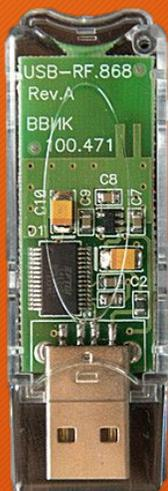
USB-RF адаптер предназначен для настройки, диагностики и сервисного обслуживания устройств со встроенными RF-модемами.
