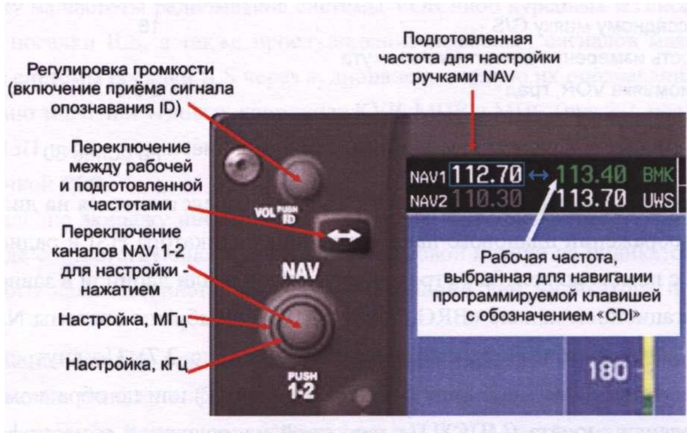
Рис. 3.2.4. Органы управления и индикации настройки систем NAV 1 и NAV 2
