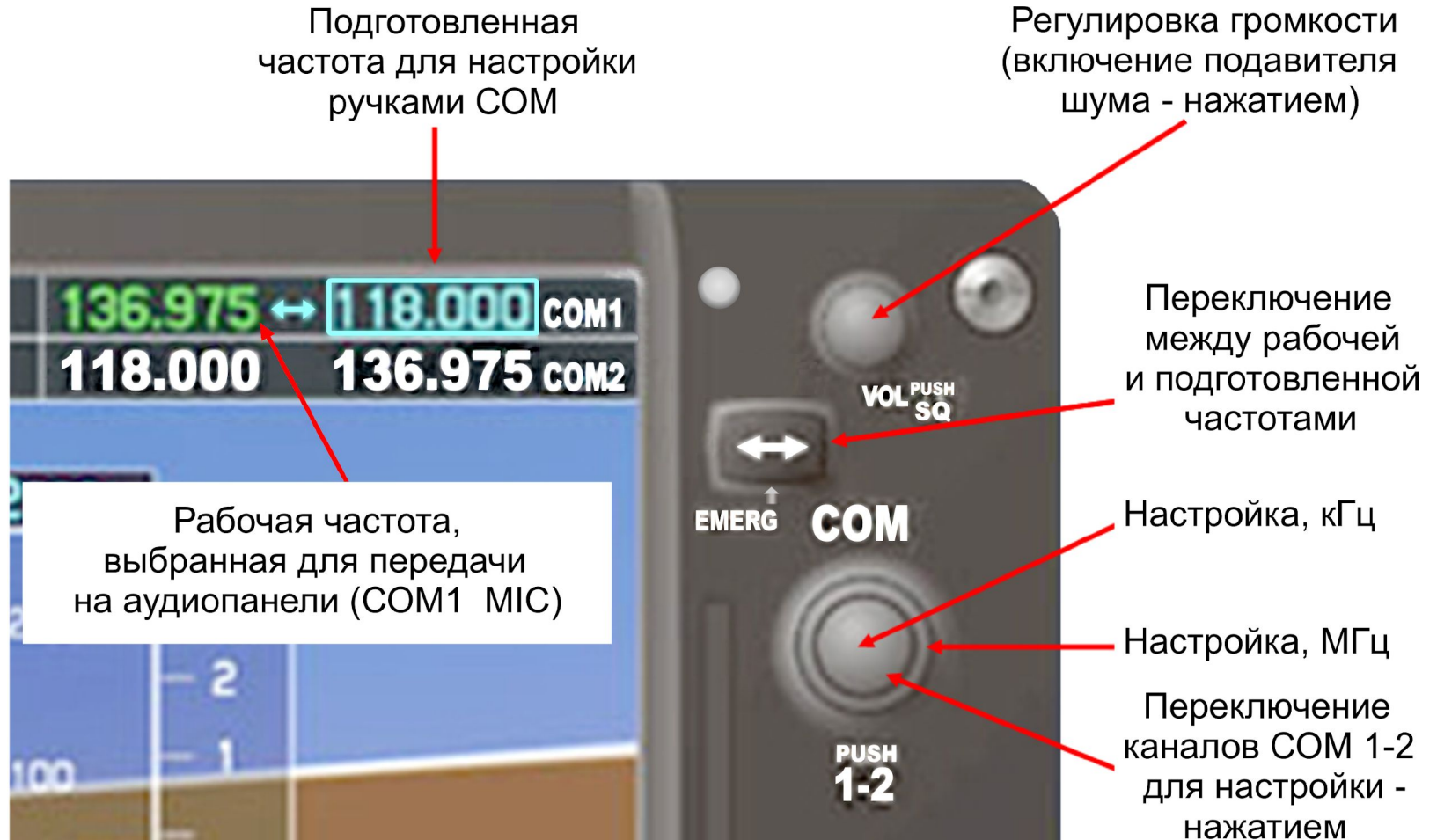
Рис.2.3. Органы управления и индикации радиостанций COM 1 и COM 2
