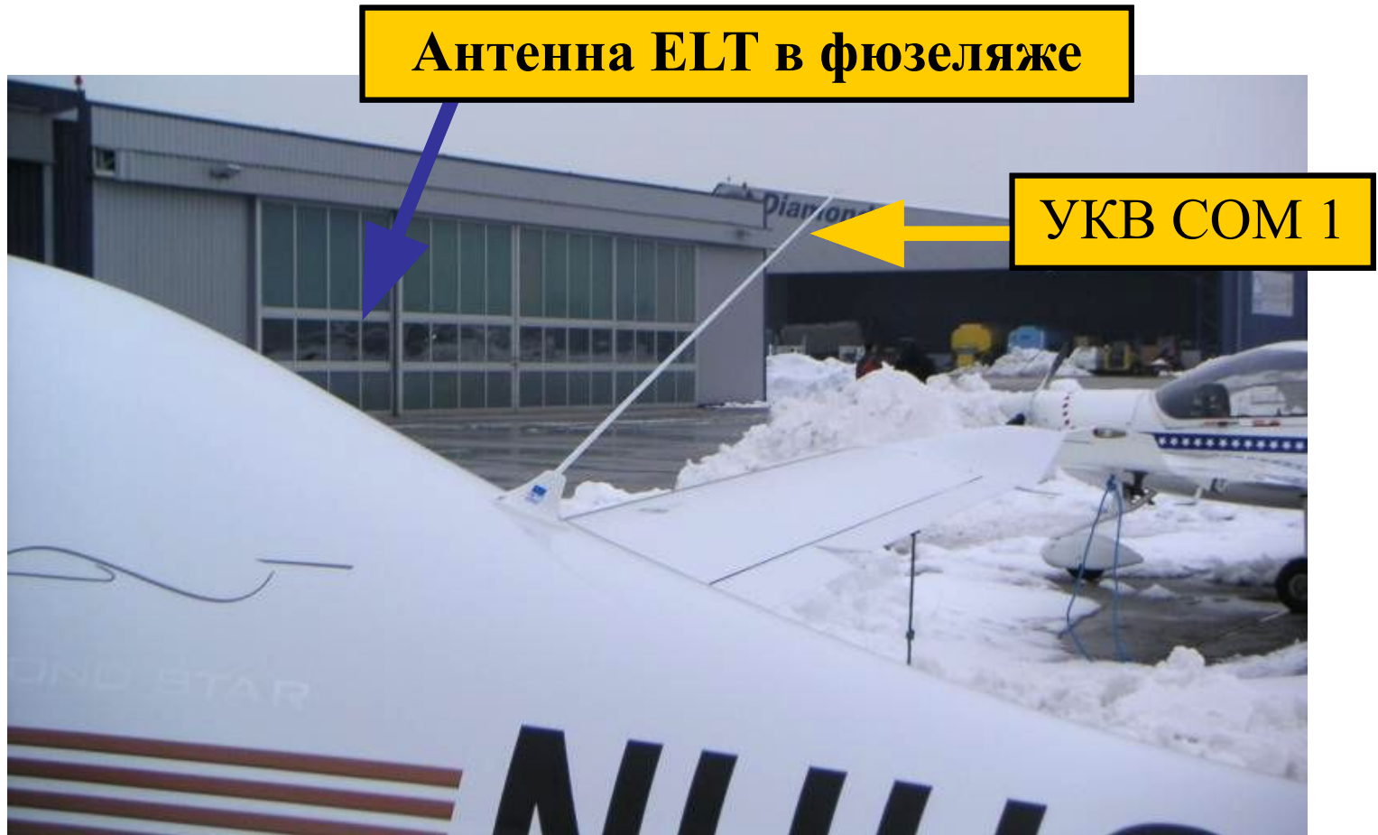
Рис 1.3. Размещение антенн ELT и УКВ COM 1
