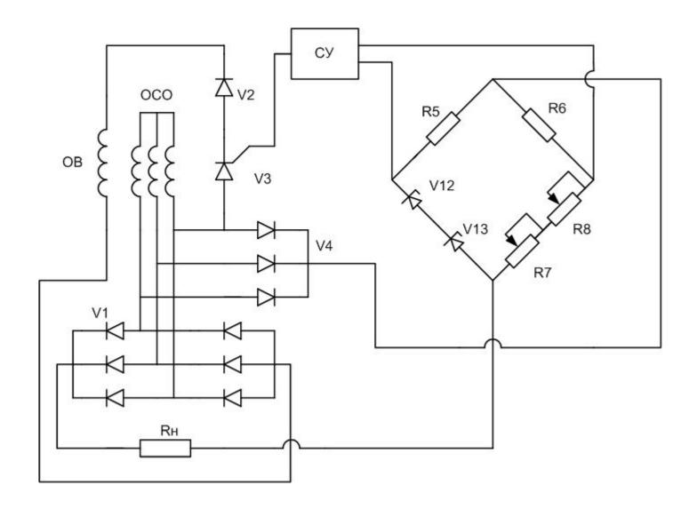
Упрощённая схема тиристорного регулятора напряжения
