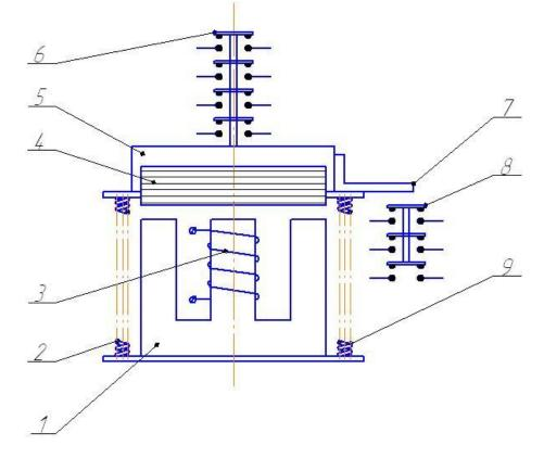
• На средний сердечник Ш-образного магнитопровода 1 насажена включающая катушка 3. Якорь 4, жестко скрепленный с траверсой 5, постоянно отжимается вверх пружинами 2 и 9. С траверсой соединены силовые мостиковые контакты 6. Вспомогательные контакты 8 переключаются кронштейном 7.
