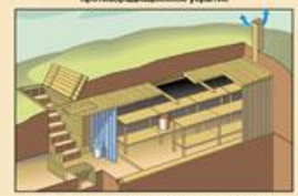
Отдельно стоящее противорадиационное укрытие из листового металла
