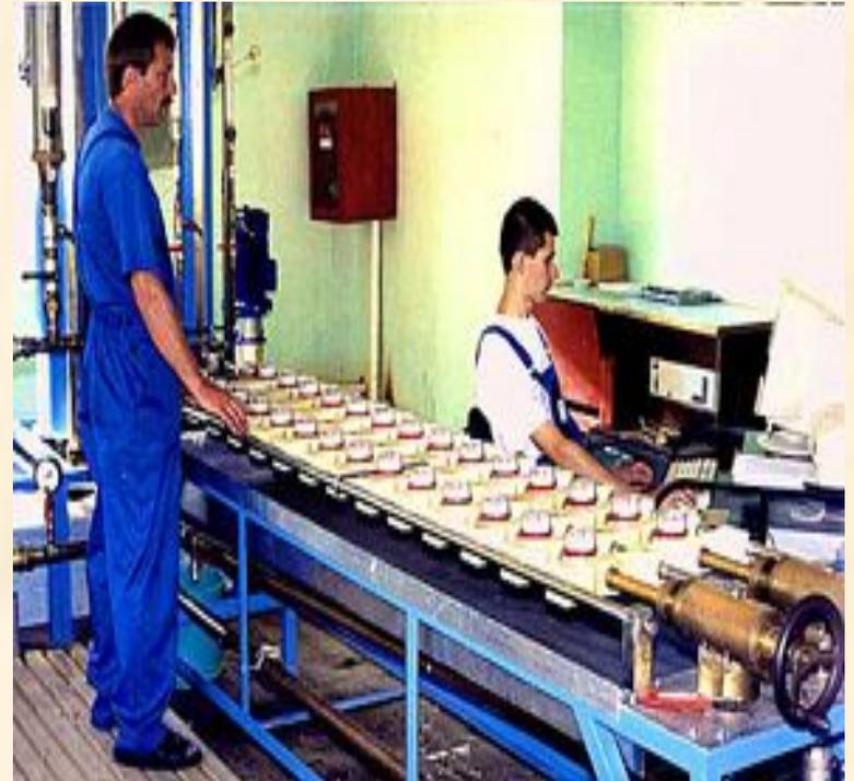
Организации поточного производства предшествует точная отработка технологического процесса и разделение его на равные или кратные по продолжительности и трудоемкости операции; установление целесообразной последовательности их выполнения.
