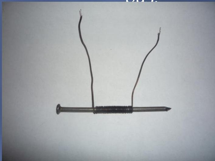
И наконец, я прикрепила концы провода к разным полюсам батарейки и проверила, работает ли электромагнит.
