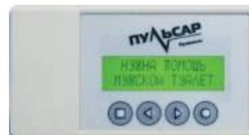
**Переносной приемник с ЖК дисплеем**
